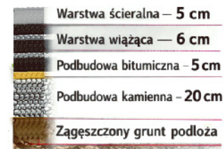
Przekrój warstw nawierzchni
